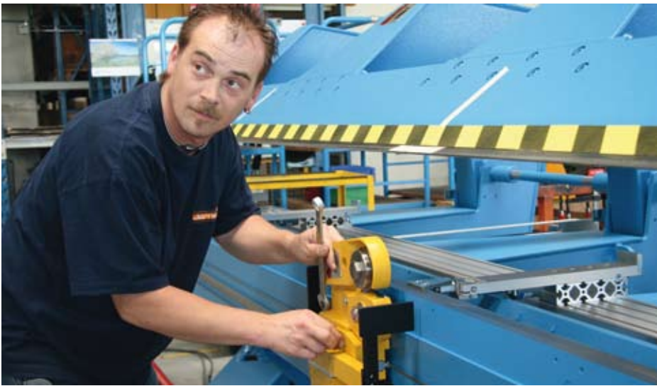
Montageleiter Bruno Blaser bringt eine neue Rollenschere in Position ...
