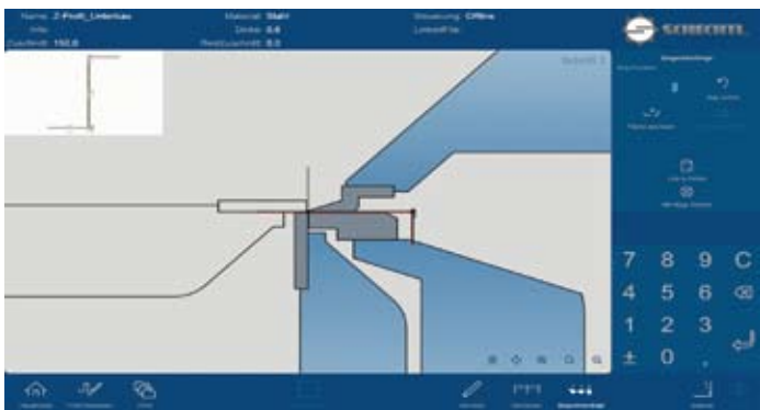
Die Bemaßung aller Winkel und Längen erfolgt direkt an der Profilskizze auf dem Display
