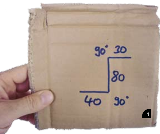
1 – 4 Von der Baustellen-skizze bis zum Erfassen des Z-Profiles bedarf es lediglich dreier Zeichenschritte
