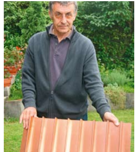
Bernhard Beck präsentiert das auf einer Wellenfaltmaschine hergestellte „Energieprofil“, auf dessen Rückseite Kupferrohre aufgelötet wurden
