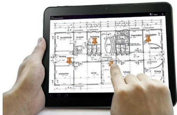
„Pinnadeln“ symbolisieren Baumängel mit unterschiedlichem Bearbeitungsstand, die mit Detailinformationen hinterlegt sind.
