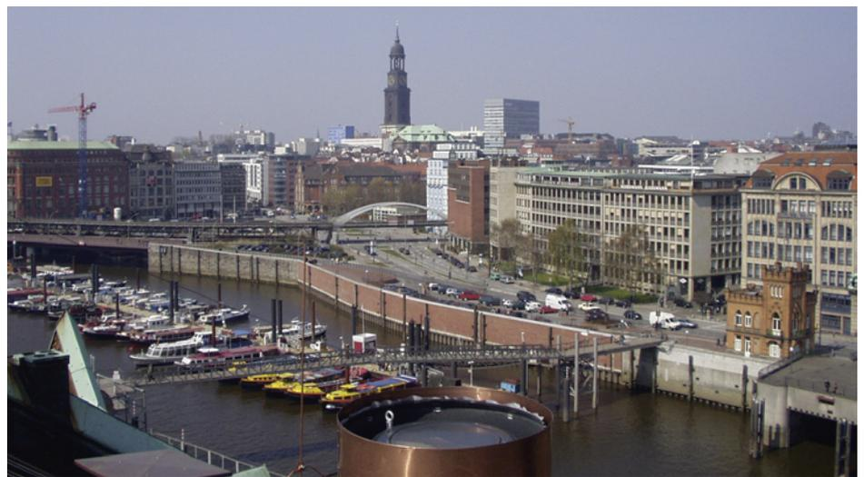
Blick von Speicherblock D 5 über das Kehrwiederfleet zum Hamburger Michel. Am unteren Bildrand ist ein Abluftventilator zu sehen, dessen Kopfstück aus pulverbeschichtetem Stahl besteht, der aus optischen Gründen mit einer Trennlage und einer Manschette aus Kupfer versehen ist.
