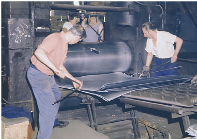
Bild 5.: Herstellung von Zinktafeln im Paketwalzverfahren.
