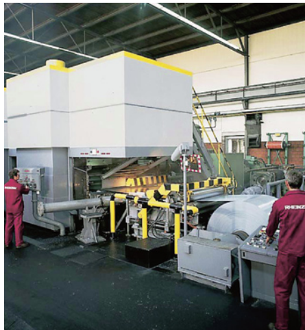
Bild 10.: Am Ende der Walzstraße wird das fertigewalzte Band zu Großcoils aufgewickelt und zur Abkühlung zwischengelagert (Bild: Rheinzink, Datteln).
