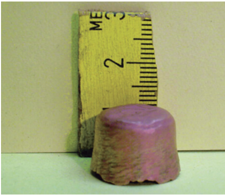
Bild 13.: Der Rumpf ist erneut abgeschlichtet worden. Er erscheint hier in seiner Oberfläche matt, weil er zuvor gegläht und gebeizt wurde.
