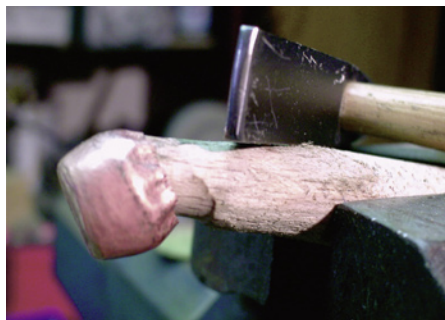
Bild 18.: Auf dem Hartholz wird der obere Rand vom Rumpf weiter mit der Finne vom Hammer eingezogen.
