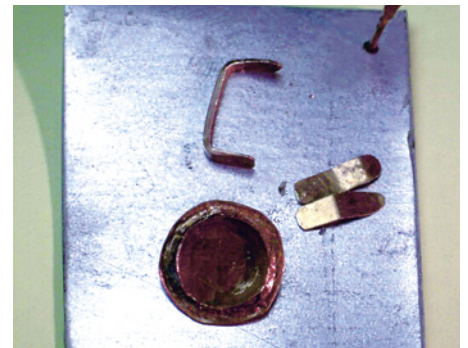
Bild 23.: Der Henkel mit den beiden Anschlussstücken und der zusammengefaltete Deckel. Aus dem Reststück wird ein Stück Draht gefertigt, aus dem dann die Niete hergestellt werden. Oben rechts im Bild sieht man in dem verzinn-tem (nicht: verzinktem) Stahlblech die Senke zum Herstellen der Niete.
