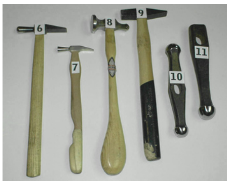
Bild 1.: 1 Polierhammer, 2 T-Eisen, auf dem geschweift wird, 3 Tellerhammer, 250 g, 4 Bördeleisen, 5 Kunststoffhammer, 6 Goldschmiedehammer, 7 Uhrmacherhammer, 8 Ziselierhammer, 9 Schlosserhammer, 100 g, 10 und 11 Treibhammer.
