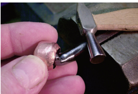
Bild 16.: Das Einziehen vom oberen Rand: über eine selbst hergestellte Kugel auf einem gebogenen Durchschläger wird mit einem kleinen Kunststoffhammer der obere Rand vom Rumpf nun eingezogen und zwischendurch mit dem Uhrmacherhammer abgeschlichtet. Achtung : aufpassen, dass beim Einziehen keine Falten entstehen.
