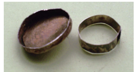
Bild 22.: Der Bördelrand vom Deckel wird auf Länge geschnitten, der Rand zusammengefaltet und verlötet. Nun werden am Rand 2 mm auf 90° geschweift. Es wird ein kleiner Kreis ausgeschnitten, in den Deckel eingepasst, der geschweifte Rand wird in den Deckel eingearbeitet und der Bördelrand vom Deckel geschlossen.
