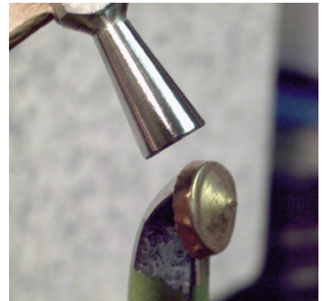
Bild 21. zeigt das Abschichten vom Bördelrand vom Deckel.
