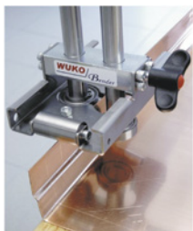
WUKO UNI BENDER bei der Herstellung einer Sicke
