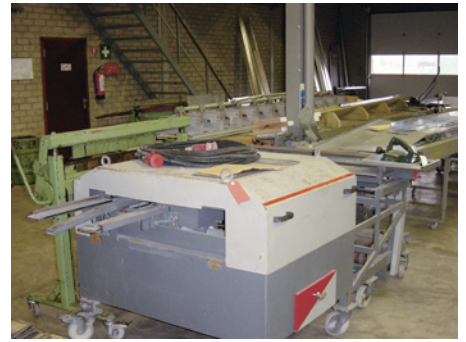
Trotz der in den Niederlanden üblichen Vorfertigung von Klempnerprofilen hat Jos Verkoelen weiterhin in seiner Werkstatt eigene Maschinen, sowohl älteren als auch jüngeren Datums (im Bildvordergrund Schechtl und Schleich).
