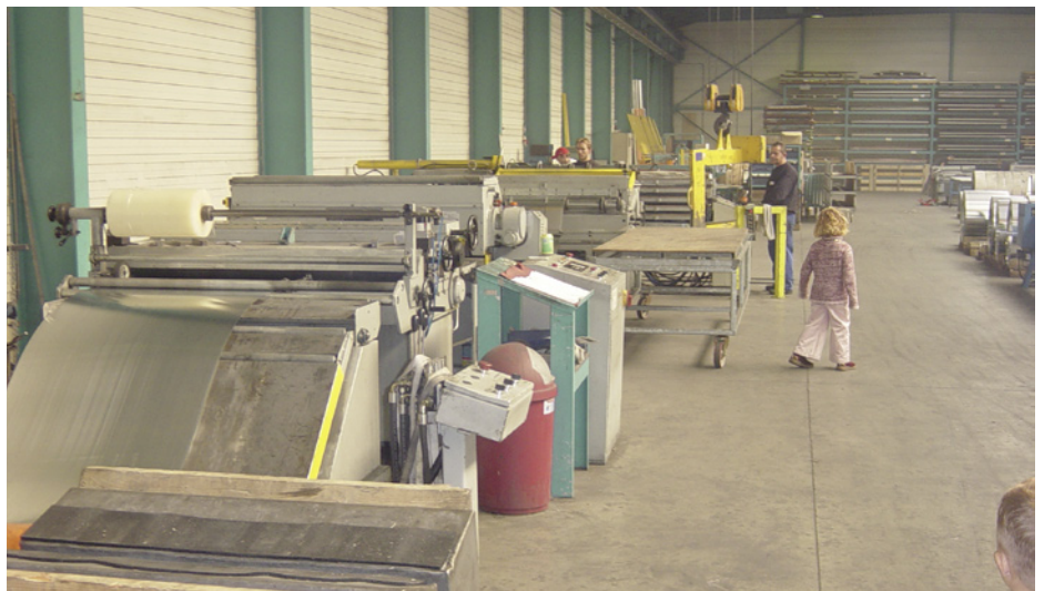
Nein, es gibt keine Kinderarbeit in Belgien. Lilian und Jos Verkoelen hatten die Werksbesichtigung ganz locker zu einem Familienausflug umfunktioniert und ihre Kinder Elisa und Viktor mitgenommen. Unser Bild zeigt den vorbereitenden Arbeitsablauf für die Auftragsfertigung. Coils mit Stückgewichten bis zu 7 t werden abgerollt und zu Bandstreifen unterschiedlicher Breite geschnitten.
