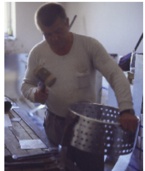
Weißrussischer Klempner bei der Herstellung eines Kiesfangs.
