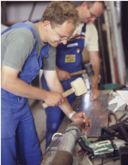
Werkstattarbeiten in Nadeshda. Im Bildvordergrund eine improvisierte Rohrstanze.
