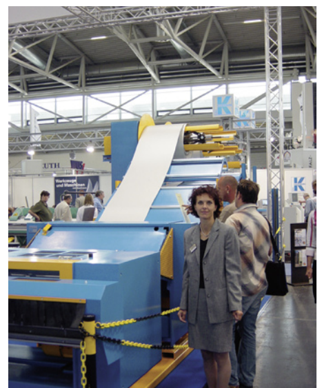
Angelika Romagna von Forstner Maschinenbau aus dem österreichischen Feldkirch vor der Sechsfach-Abcoilanlage mit Längs- und Querteileinrichtung und automatischem Coilwechsel.
