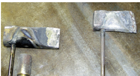
Gebrauchte Lötstücke nach 100 Stunden Non-Stop-Betrieb im Vergleich: links Zinnlux – rechts herkömmlicher Lötcolben.
