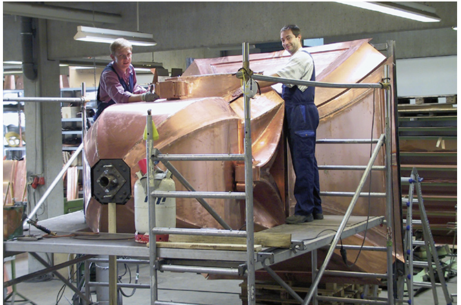
Eine der beiden Laternen kurz vor der Fertigstellung. Wolf-Peter Neuwirth (l.) und Wilhelm Denzel beim Verputzen der Laternen. Unter Verputzen versteht man das Säubern der Oberfläche mit feinem Schleifvlies.
