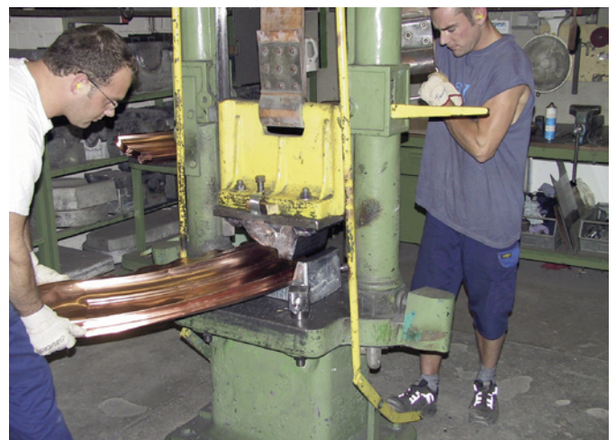
Gaston Gödicke (l.) und Thomas Mitter beim Herstellen von gerundeten Kupferkonsolen am Fallwerk in der Ulmer Werkstatt.
