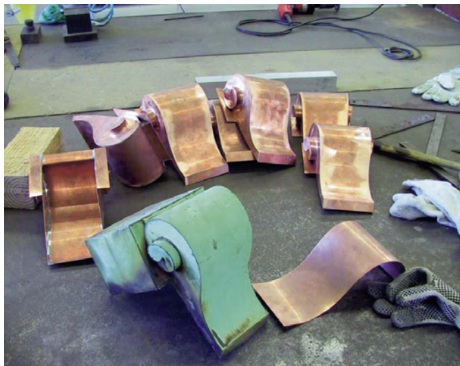
An diesen Zierteilen gab es viel zu löten: eine alte und sechs neue doppelseitige Schnecken.
