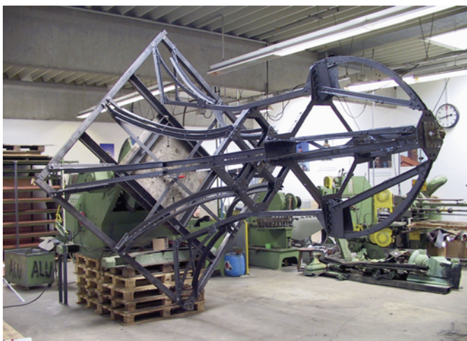
... das durch eine verzinkte und anschließend Schutzlackierte Stahlunterkonstruktion ersetzt wurde. Zur besseren Montage der Kupfertteile sind sie an einem Dreh-Kipptisch montiert.
