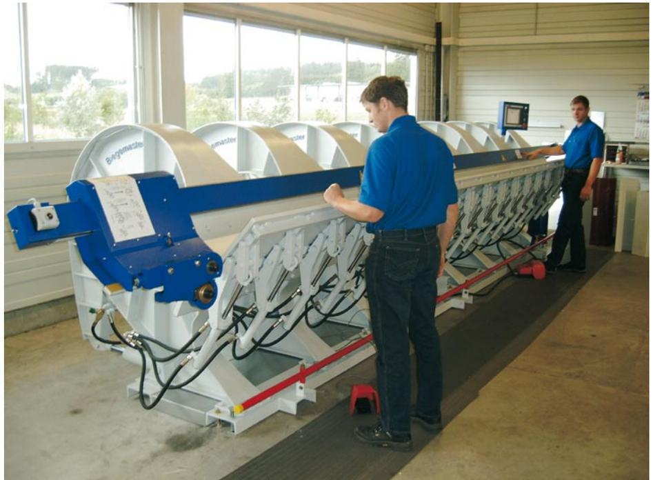
Die beiden Brüder Uli (l.) und Rainer Wackenhut bei den ersten Gehversuchen mit der Biegemaster-Langabkantmaschine des Typs BS 6.3,00 von Sperr & Lechner.
