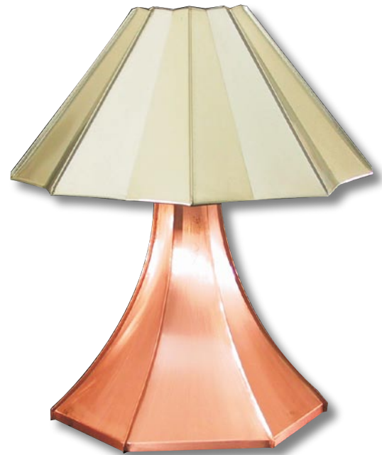
Das Meisterstück von Konrad Georg Blumberger: Eine Tischlampe mit nach unten erweitertem, geschwungenem sechsseitigen Fuß aus 0,6 mm dickem Tecu-Classic mit einfacher Stehfalzverbindung und Vierkantsockel. Der achtseitig gefaltete Schirm besteht aus Tecu-Zinn, ebenfalls 0,6 mm dick. An den Graten befinden sich einfache Stehfalzverbindungen sowie eine unterseitige Rundkupfereinlage von 3 mm Durchmesser.
