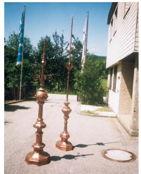
Bild 5.: Diese beiden Turmspitzen entstanden in der Werkstatt von Friedrich W. Parzer. Drei Ausführungen der links abgebildeten Turmspitze, die 2,35 m hoch ist, schmücken die beiden Nordtürme und den Südturm. Die 3 m hohe Turmspitze rechts mit ihrem neuneckigen Sockel fand ihren Platz auf der Laterne der Hauptkuppel.
