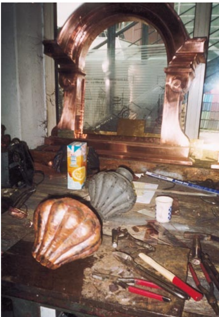
Bild 7.: Für die Turmspitzen auf den beiden Nordtürmen und dem Südturm waren getriebene Pfeifenornamente herzustellen. Mit Hilfe eines Holzmodells gelang die knifflige Arbeit. Auch für die Herstellung des im Bildhintergrund gezeigten Ornamentfensters ...
