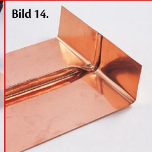
Herstellung eines umgelegten Stehfalzes.
