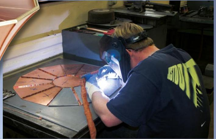
Bernhard Dietrich aus Rottenburg weiß, dass eingelegte Stahlstücke bei WIG-Schweißarbeiten die Wärmeeinbringung reduzieren.
