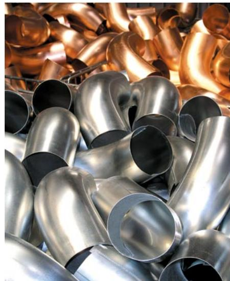
Die meisten Produkte für das Dachentwässerungszubehör – hier Rohrbögen für kreisrunde Regenfallrohre – fertigt Minoletti aus Kupfer und Titanzink.
