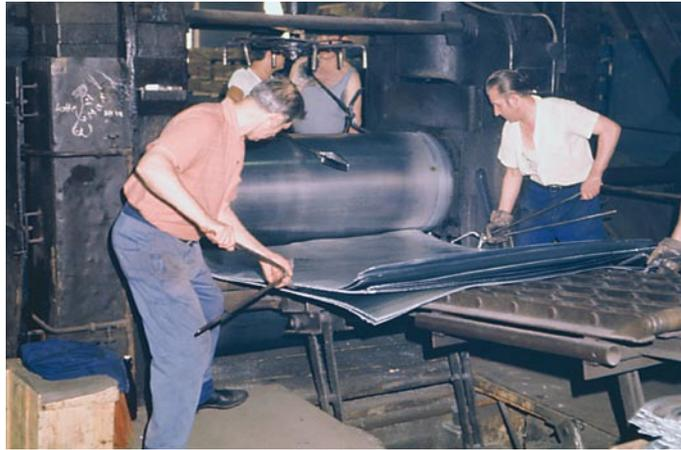
Bild 22.: Die Herstellung von Zinktafeln nach dem Paketwalzverfahren wurde ab dem Jahr 1965 abgelöst ...
