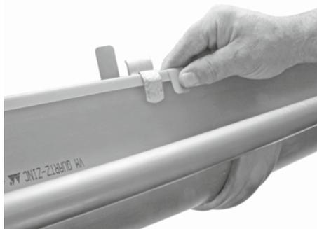
Bild 3.: Durch Umlagen der Spannlaschen (Federn) wird die Blende fixiert und die Dachrinne zusätzlich im Rinnenhalter befestigt.
