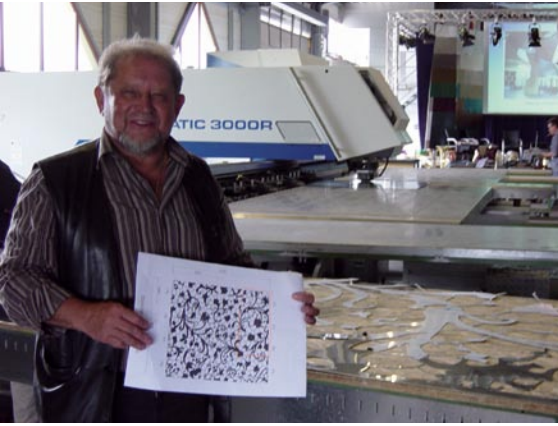
Heinz Lummel zeigt ein Blumendekor, das im Kundenauftrag maßgenau, aber in viel größeren Dimensionen auf der Nibbel- und Stanzmaschine Trumatic 3000R in Edelstahl hergestellt wird.
