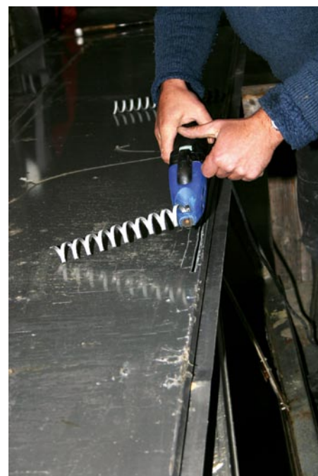
Im Schneidkopf der Trumpf C 250-0 Plus ist eine spezielle Spanführung eingebracht. Dadurch rollt der Span gleichmäßig und spiralförmig ab. So wird der Eigenvorschub unterstützt und die benötigte Vorschubkraft minimiert.
