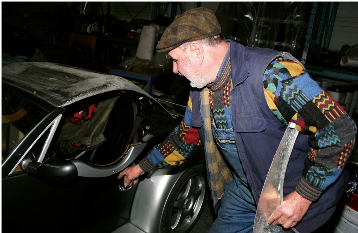
Seniorchef Peter Sautter hat an seinem Traumwagen, einem Morgan, den Fensterausschnitt mit Hilfe der Trumpf-Schlitzschere C 250-0 Plus „tiefer gelegt“.
