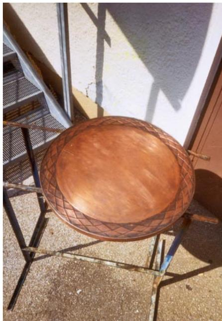
Die Kupferplatte hat an den Tischrändern selbst hergestellte Rautenverzierungen und ist mit einem Bitumenkaltkleber auf der darunter liegenden Spanplatte fixiert.
