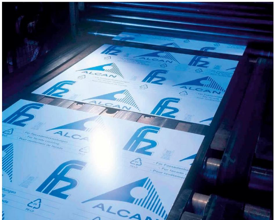
Bild 4.: Zuschneiden von Tafeln auf einer Spaltanlage.
