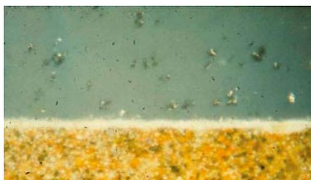
Bild 7.: Schnitt durch eine bandbeschichtete Oberfläche bei tausendfacher Vergrößerung.
