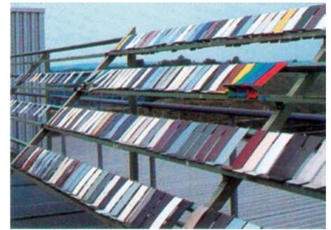
Bild 9.: Außenbewitterungsanlage zur Überprüfung des Langzeitverhaltens der Farbbeschichtungen an der Atmosphäre.
