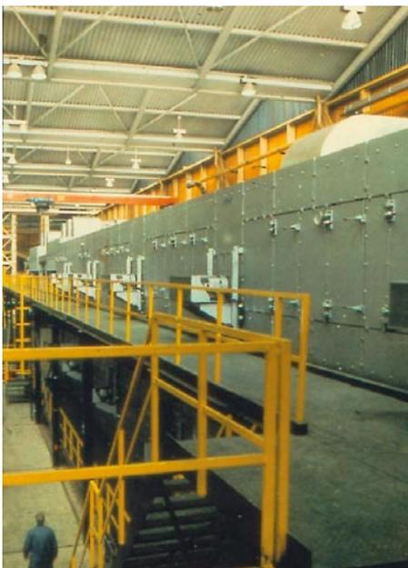
Bild 2.: Der Heißteil besteht aus den Trocknern zum Einbrennen der Beschichtung, der thermischen Nachverbrennung (TNA) und der Wärmerückgewinnung.
