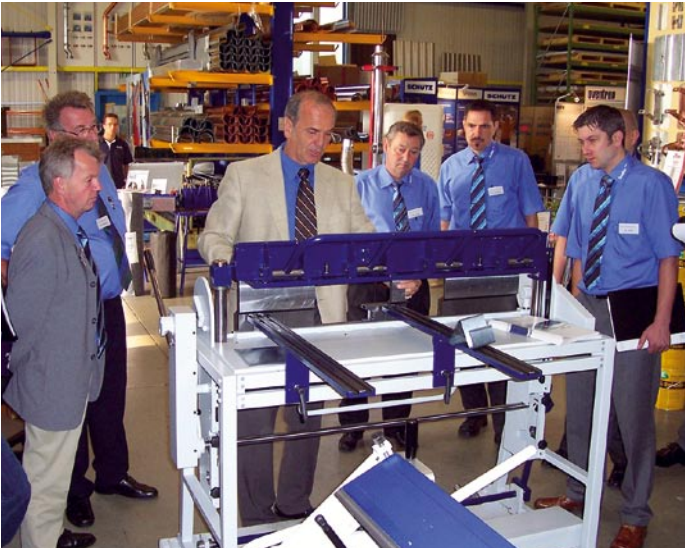
Die Schröder Maschinenbau GmbH aus dem bayerischen Wessobrunn-Forst stellte verschiedene Maschinen für die effiziente Spenglerei vor, darunter auch die mehrstufige Universal-Segment-Abkantmaschine.
