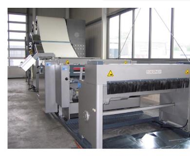
Sechs Abwickelgeräte in Kombination mit dem Mehrfachtisch ermöglichen einen raschen Blechwechsel.
