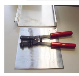
sich die Biegekanten der Unterdeckung ebenfalls durch nur einen Druck erstellen. Somit entfallen mehrere Arbeitsgänge wie beispielsweise ein beidseitiges Anreißen und das Wenden der Bleche. Weitere Informationen: M.A.S.C. Arbeitsmittel-Vertriebs GmbH, Funkweg 12a, 89250 Senden, E-Mail: hotline@masc-senden.de, Tel.: (0 73 07) 92 94 40, Fax: (0 73 07) 92
