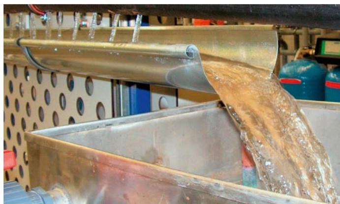
Bild 4.: Die Seite der Rinne mit Rinnenböden. Im Bild ist rechts zu erkennen, dass die Rinne (bei 180 l/min) überzulaufen beginnt.
