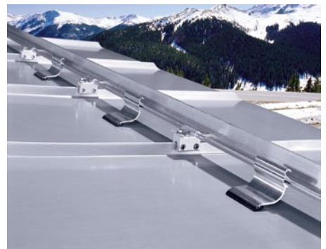
Rheinzink-Schneefang, System S5. Die Schneefangklemme auf dem Doppelstehfalz hält die Schneefangschiene sicher fest. In der Scharenmitte sind Eishalter angeordnet.
