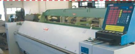
SCHECHTL Motorabkantmaschine Typ MAB 300/8M, 3040x2,5mm, mit PNC-3-Achsen CNC-Steuerung, Hinteranschlag, Geißfußschiene, Bj. Ca.1993/2005 werksüberholt
