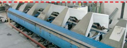
TENSOL TEWE 6-3,0mm Abkantmaschine, Bj. 1990 hydr. Abkantmaschine 6000x3,0mm mit CNC gest. Anschlag, hydr. Radiusverstellung, Steuerung PC 4000, o. Schere, Oberwange vor 2 Jahren komplett erneuert, Vorsatzeinheit
