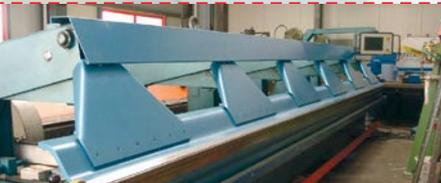
THALMANN hydr. Abkantmaschine Typ Thako 20/8,2, 8000x2,0mm, mit neuer CNC-Touch-Grafik-Steuerung, Hinteranschlag, hydr. Motorschere bis 1,5mm, Bj.1991/2005 überholt
