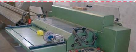
BM-Schaffhausen, Längs- und Querteilanlage, Typ KSA, 1250 x 1,25mm, mit 3 Rollen-Richteinheit, Querteilschere, 4-Spaltmesserpaare, Auswerfeinheit, ELGO-Steuerung, Bj. 1985/überholt 2002,
