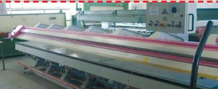
Biegemaster hydr. Abkantmaschine Typ BMTH-6x1,5, 6020x1,5mm, mit Einfach-Programmsteuerung, Vorsatzeinheit, Motorschere bis 1,5mm, Bj. 1998, sehr wenig Betriebsstunden
