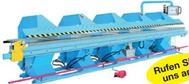
JORNIS-6-Meter hydr. Abkantmaschine Typ NL 125, 6000x1,25 mit CNC-Touch-Grafiksteuerung, Hinteranschlag, hydr. Motorschere bis 1,5mm, Vorführmaschine Baujahr 2005
