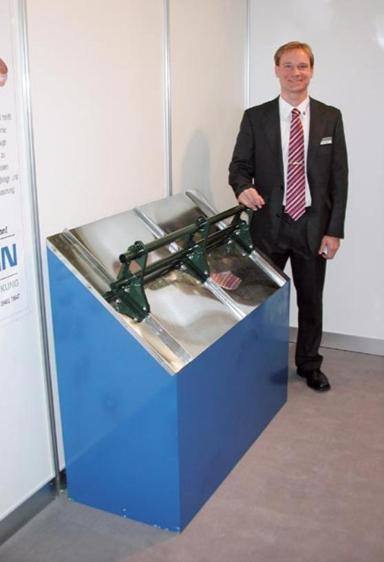
Wie man verhindert, dass vom Metaldach Schneelawinen abgehen, machte Markus Bauer von der Firma Otto Lehmann GmbH aus Neutraubling deutlich: Schneefangstützen in der Flucht an den Stehfalzen befestigen, Rohre einlegen, Rohrbefestigung anklammern, fertig!
