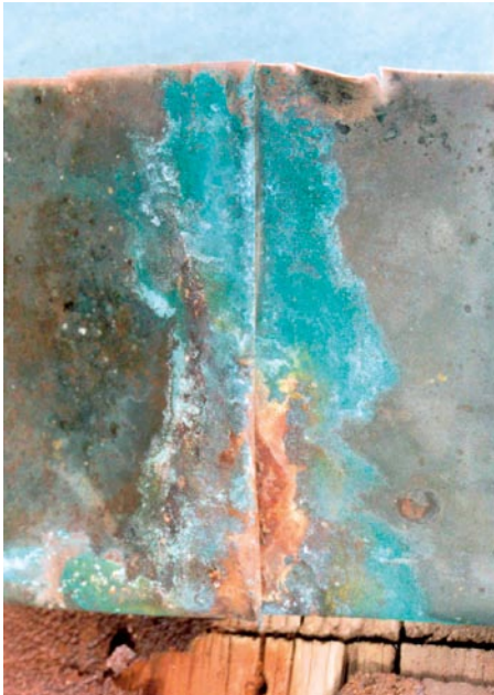
An diesem stark oxidierten Eisenblech saß früher einmal ein Eisenhaft.
