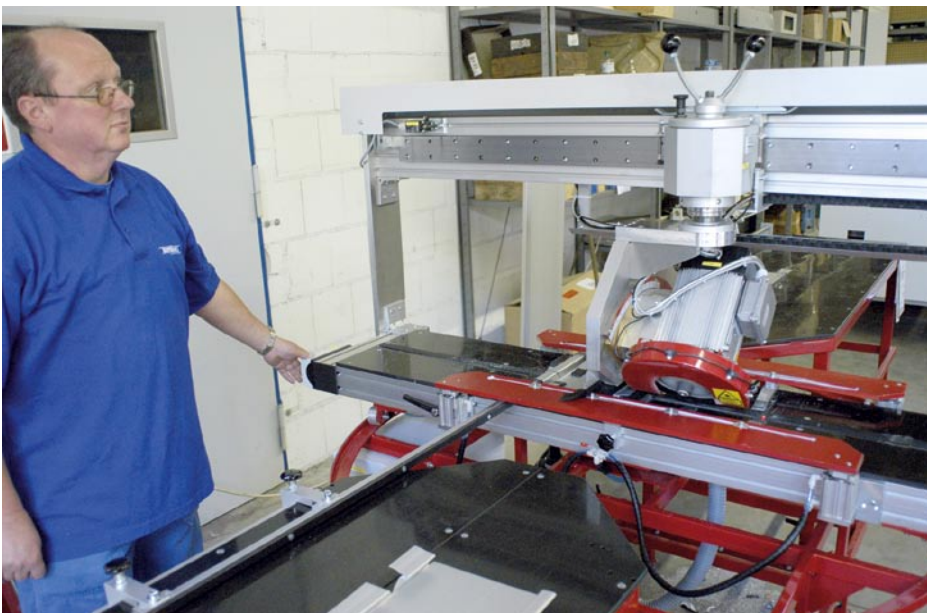
Justage ist alles: Komplexe Systeme wie dieser Rollformer Quadflex für vier unterschiedliche Profile erfordern höchste Präzision.
