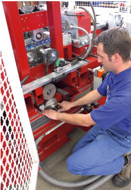
Justage ist alles: Komplexe Systeme wie dieser Rollformer Quadflex für vier unterschiedliche Profile erfordern höchste Präzision.
