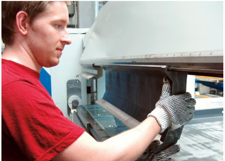
Bediener Maik Voss: „Verglichen mit den Pressen sind wir beim Rüsten der Gigabend doppelt so schnell.“
