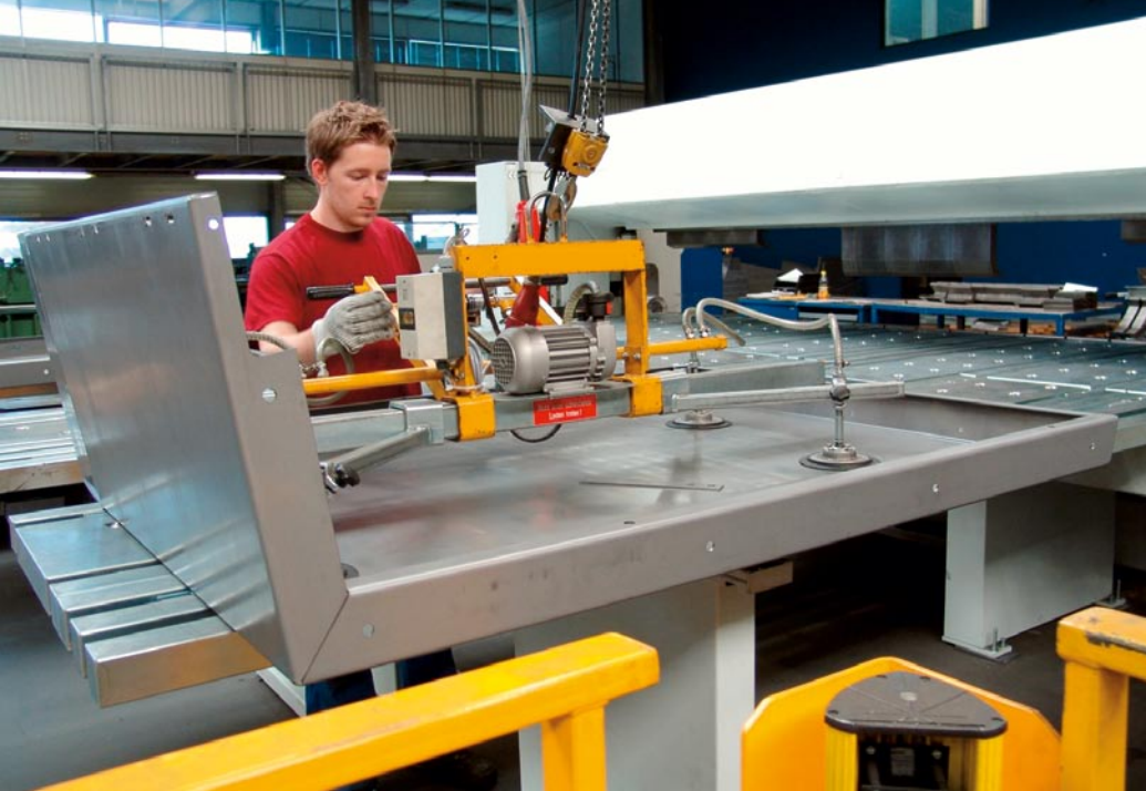
Selbst große Biegeteile kann ein Bediener mit Hilfe eines Krans allein entladen.
