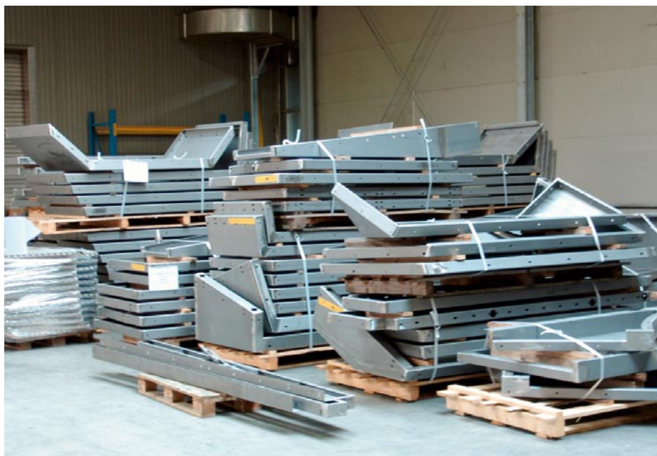
Produktionsleiter Karl Hartl: „In der Saison fertigen wir eine Seilbahnstation pro Tag. Was heute gestanzt und gelasert wird, geht morgen zum Biegen und übermorgen zum Pulvern.“
