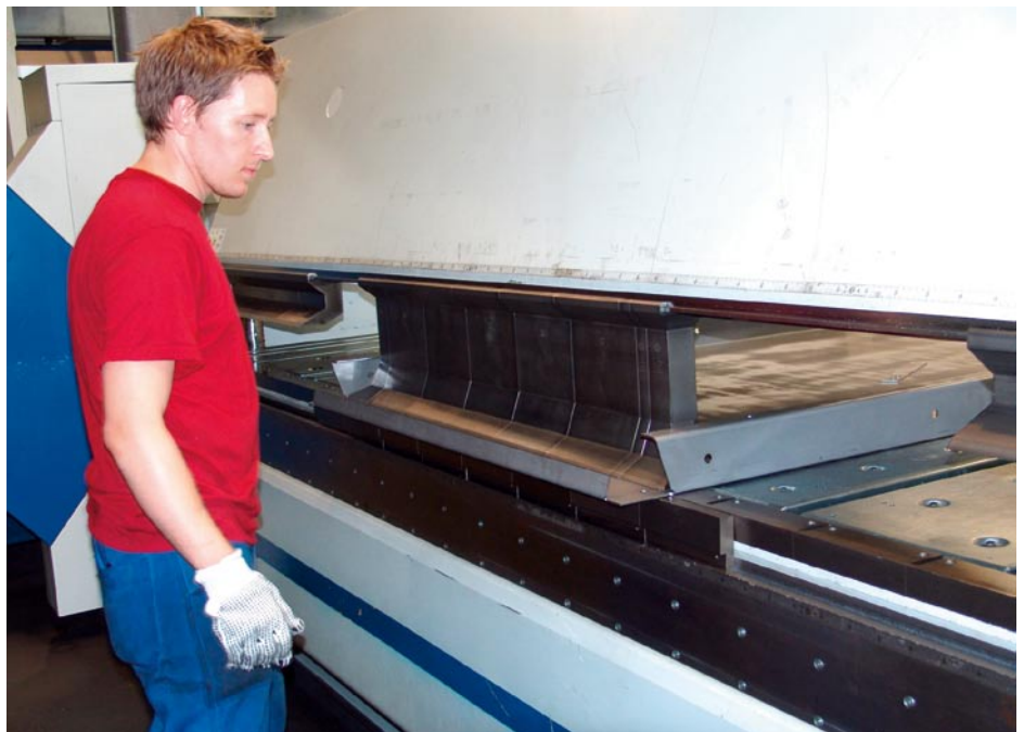
Teilweise genügt eine Werkzeugstation. Bei komplexen Biegeteilen ist schon einmal ein Mehrstationen-Aufbau erforderlich.
