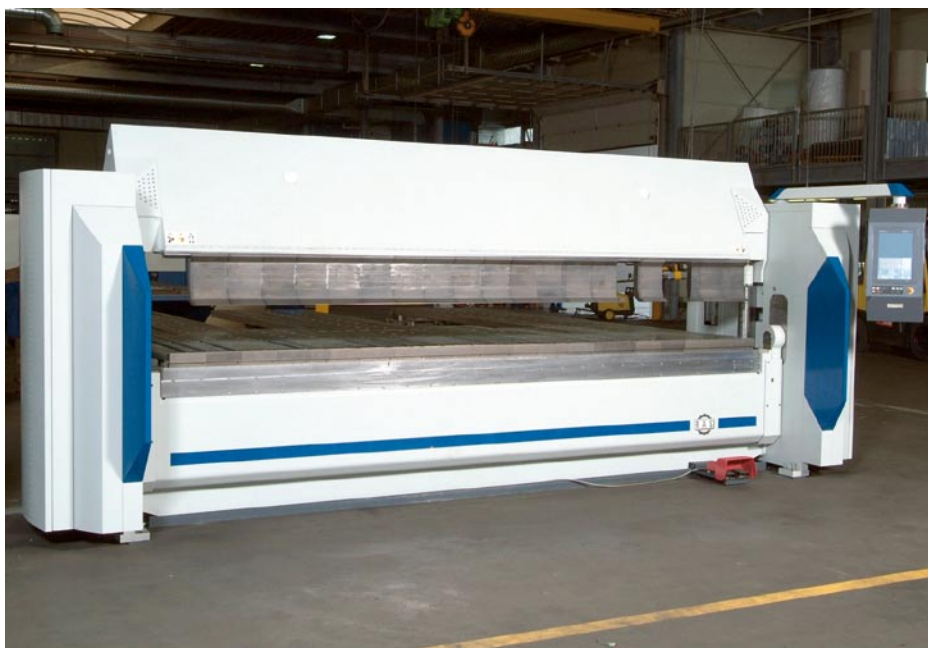
Die Schwenkbiegemaschine RAS Gigabend mit 4060 mm Arbeitslänge und 5 mm Biegeleistung.
