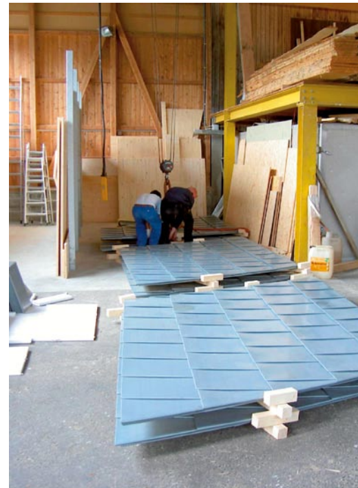
In der Werkstatt produzierten Stephan Sutter und seine Spengler vorab komplette Fassaden- und Dachbekleidungen aus Rheinzink-Rauten.
