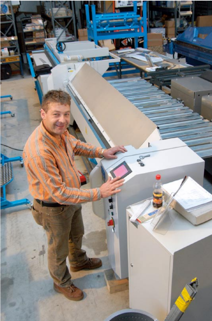
Easy Control und Schwarzweiß-Display statt aufwendiger Grafik: Die neue Programmsteuerung der Schwenkbiegemaschine MAX 310 EC von Schechtl wurde von Kundendienstleiter Robert Wimmer mitentwickelt.
