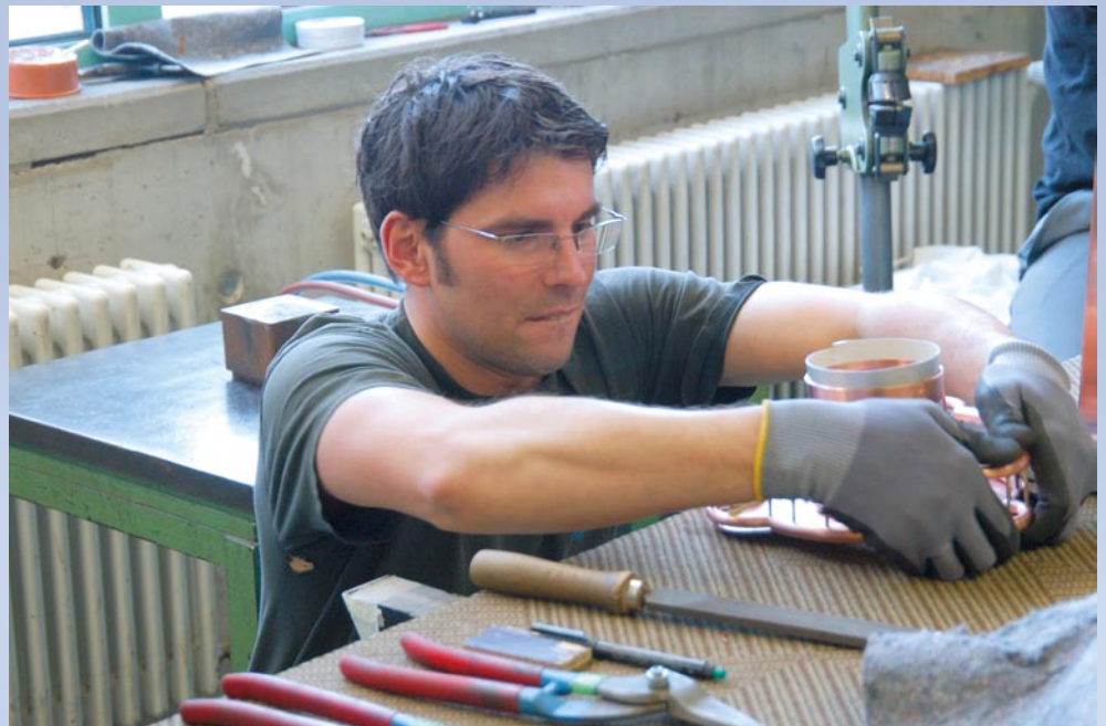
Licht ins Dunkel bringt Sascha Betzler aus Stuttgart mit seinem kupfernen Leuchtturm. Der Turmschaft besteht aus sechs nach innen gefalzten, 0,7 mm starken Segmenten, die punktweise verlötet sind, und einer sechseckigen Bodenplatte. Am oberen Ende des Schaftes tragen drei Erker mit kegelförmiger Basis und unten eingeschraubter Messingkugel die Grundplatte für das Laternenhaus. Diese Aussichtsplattform aus 1,0 mm dickem Kupfer ist aus einem großen Kreis sowie drei kleinen, angesetzten Kreisen konstruiert und ringsum 4 mm hoch aufgekantet, damit das umlaufende Geländer aus genuteten, hartgelöteten Kupferrohren und Messingstäben aufgesteckt werden konnte. Der verglaste Laternenraum auf einer zweiten, unsichtbar angelöteten Kupferplatte wird durch eine Sicke in Position gehalten und ist darunter umgebördelt. Als Dach dient eine getriebene Halbkugel aus 0,8 mm starkem Kupfer.
