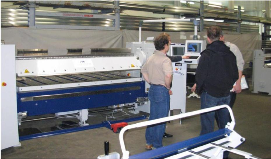
Die Schwenkbiegemaschine Multi Power Bend MPB mit motorisch drehbarer Oberwange präsentierte der Maschinenhersteller Schröder aus Wessobrunn.
