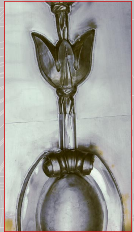
Nahtvorbereitung zwischen Blüten und Medaillon mit vorgefertigtem Verbindungsteil zum einseitigen Auflöten über dem späteren Querfalz.
