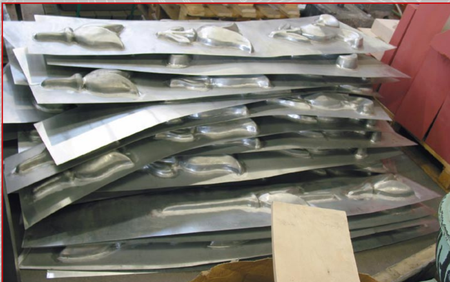
Nahtvorbereitung zwischen Blüten und Medaillon mit vorgefertigtem Verbindungsteil zum einseitigen Auflöten über dem späteren Querfalz.
