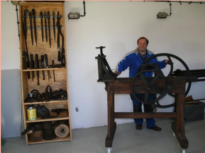
Bild 7.: Klempnermeister Thorsten Kahl präsentiert eine historische Gesimsziehmaschine.
