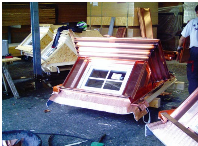
Bild 2.: In der Werkstatt des Klempnerfachbetriebes Schuko Metallbedachungen aus Recklinghausen entstehen Gauben wie am Fließband.
