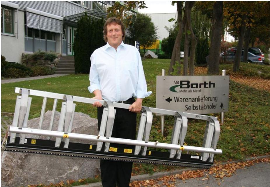
Harald Baisch, Prokurist des Handelshauses Barth in Renningen, demonstriert den einfachen Transport der als Aluminium-Leichtbaukonstruktion konzipierten Bau-Abkantbank.
