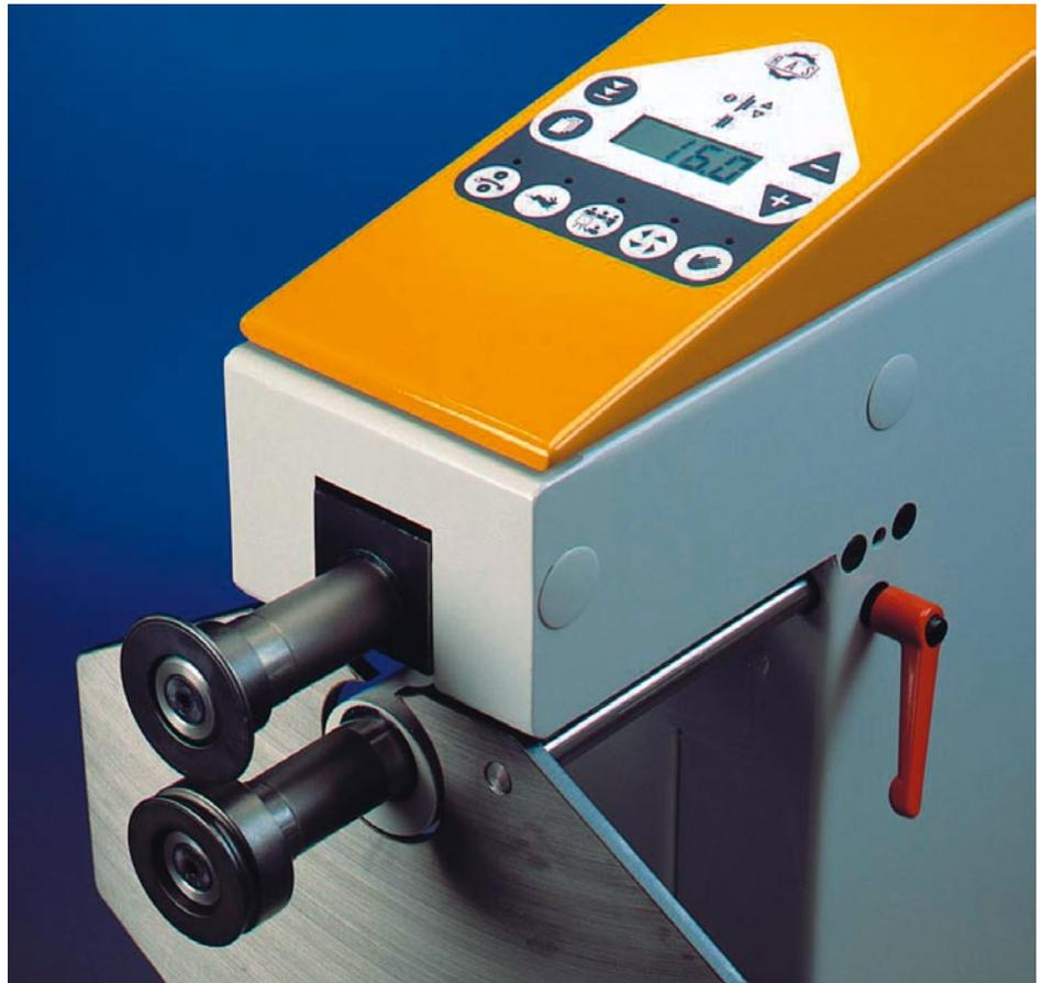
Bild 6.: Die intelligente Sickenmaschine RAS 12.35.
