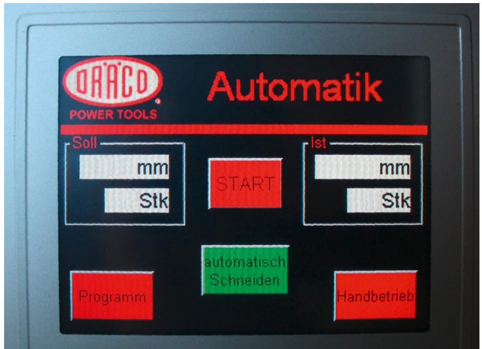
„Touch Screen“-Steuerung der Dräco-Profilmaschinen K1-W-VA/800 und K1-W-VA/1000.
