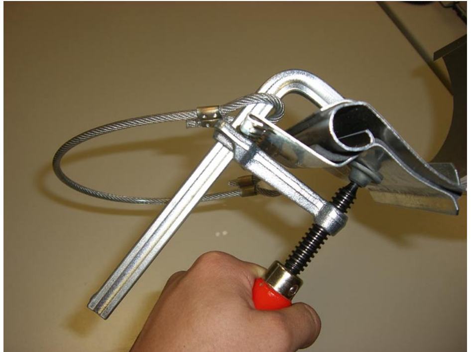
Die M.A.S.C. Leitersicherung verhindert das Abrutschen von an der Dachrinne angelegten Leitern.
