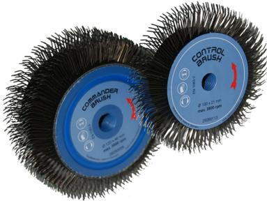
Die Drahtspitze streicht nicht wie bei allen herkömmlichen Rundbürsten nur über das Werkstück sondern durch die Abbiegung der Borsten gegen die Arbeitsrichtung trifft die gehärtete Spitze frontal auf die zu bearbeitende Fläche.
